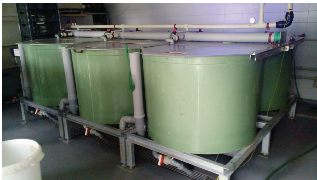
Obrázek 15: Vnitřní recirkulační systém (foto: Petr Blabolil).
