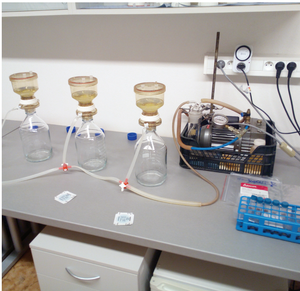
Obrázek 5: Filtrace vzorků za využití filtrační jednotky a vakuové pumpy.
