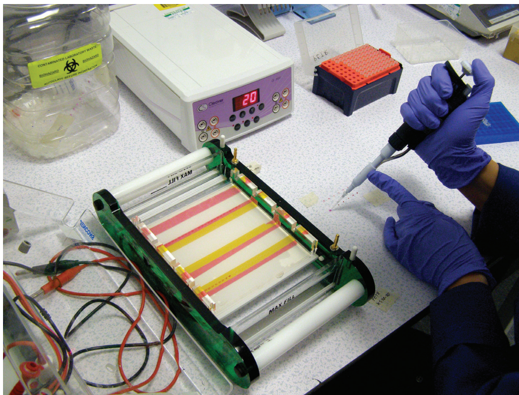
Obrázek 7: Příprava vzorků k vizualizaci produktů první PCR při elektroforéze.
