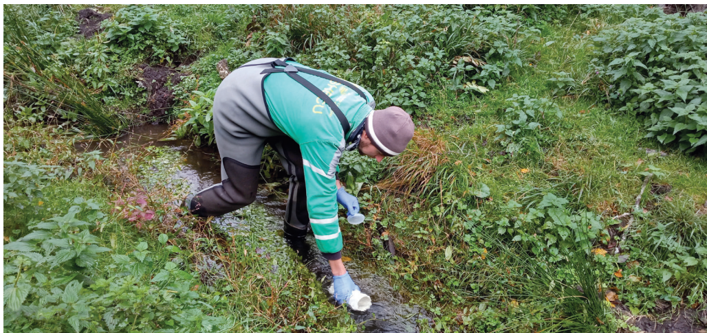
Obrázek 2: Odběr vody pro analýzu eDNA do sterilní odběrové nádoby.
