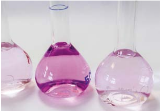
Colorimetric determination of nitrate. / Kolorimetrické stanovení dusičnanů. Foto: P. Porcal.
