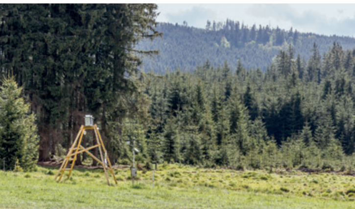
Meteorology station — bulk precipitation measurement. / Meteorologická stanice – měření srážek. Foto P. Porcal.
